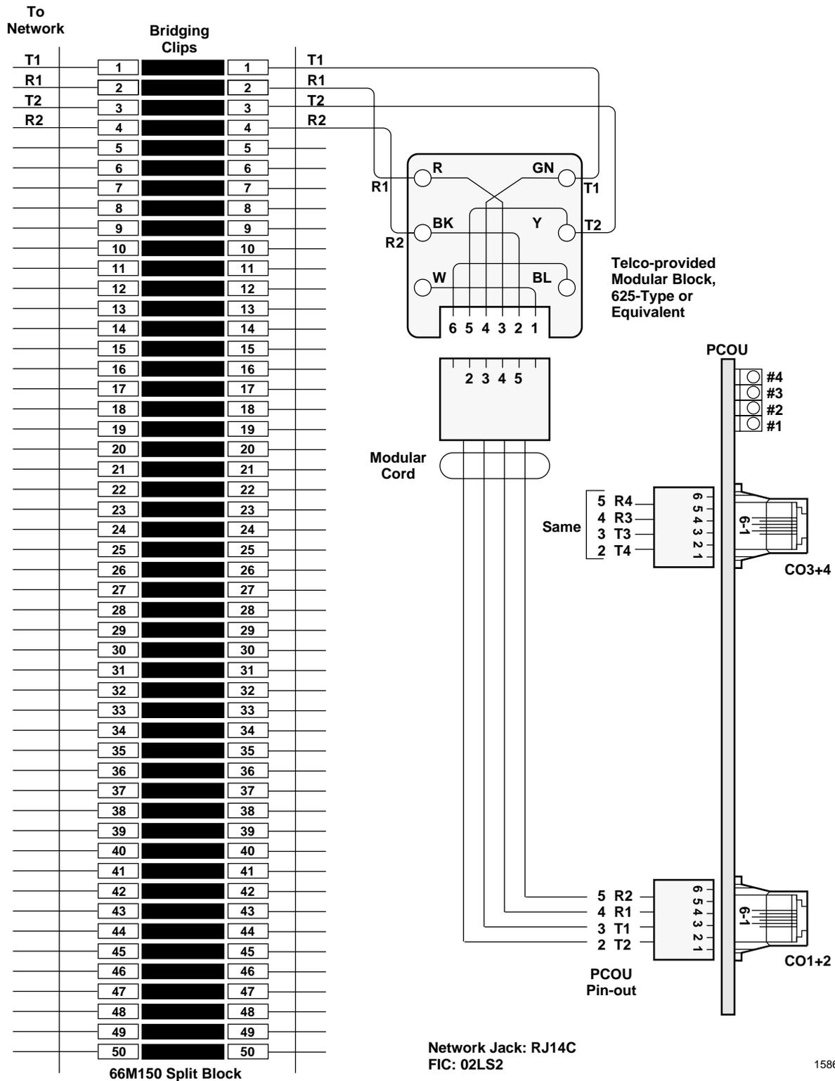
DK40i/DK424 Universal Slot PCB Wiring
