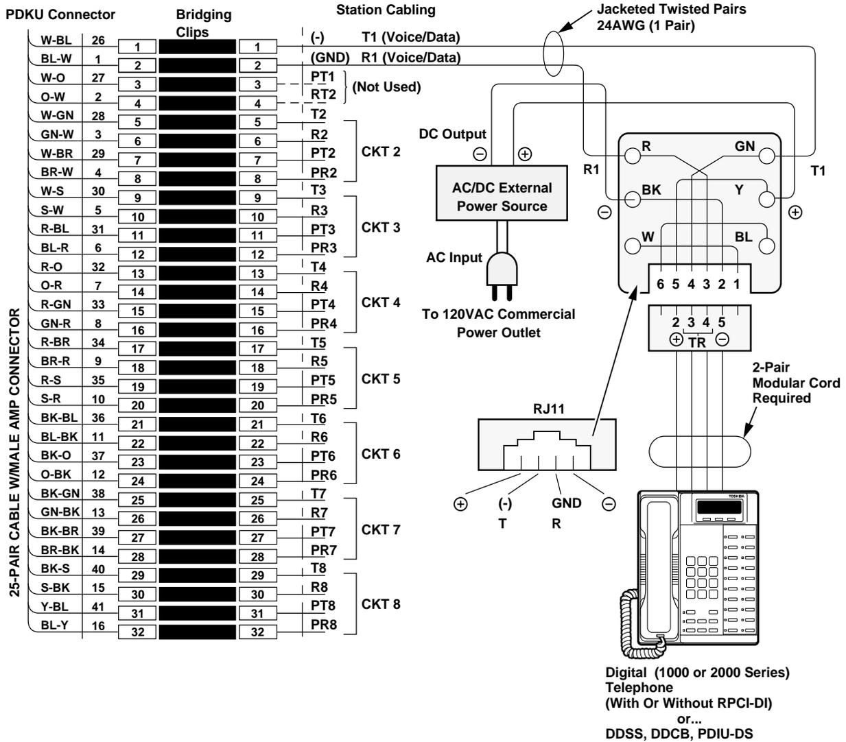
DK40i/DK424 Universal Slot PCB Wiring
