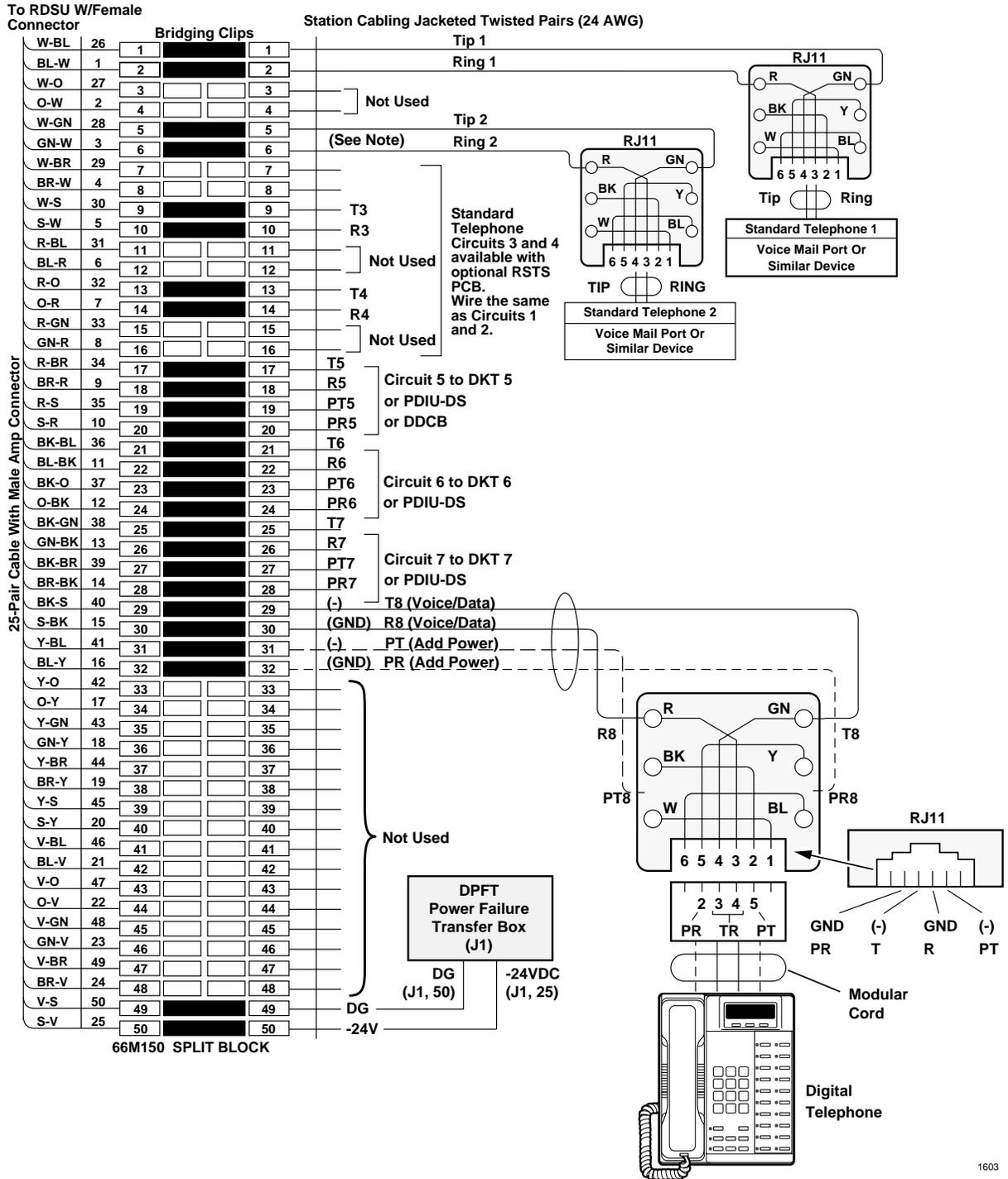
DK40i/DK424 Universal Slot PCB Wiring
