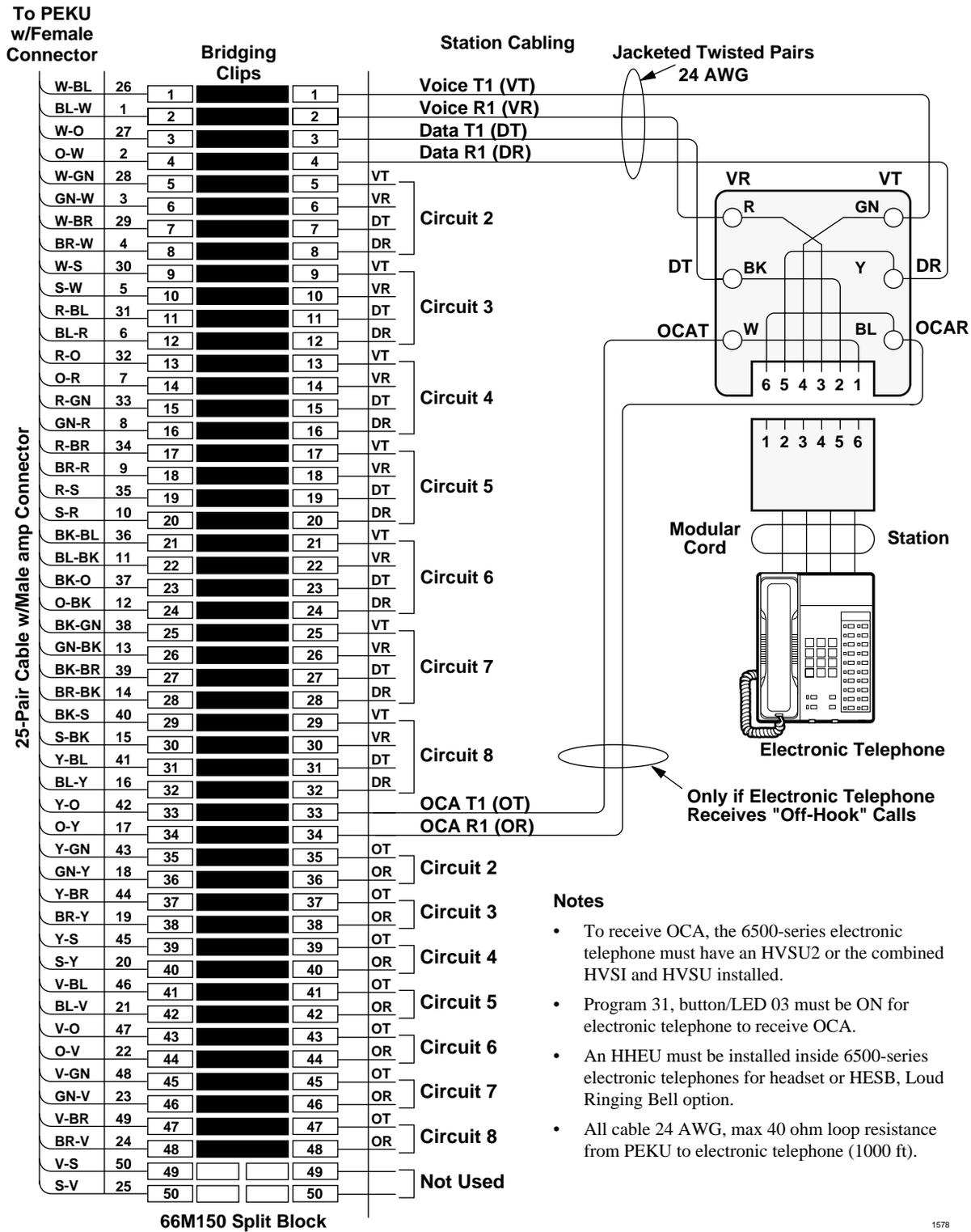
DK40i/DK424 Universal Slot PCB Wiring
