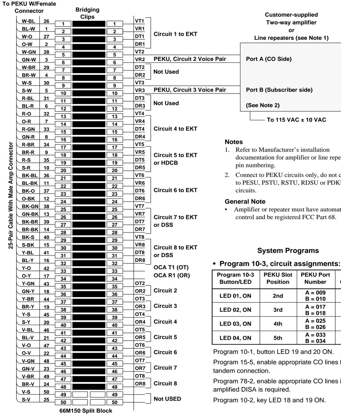
DK40i/DK424 Universal Slot PCB Wiring
