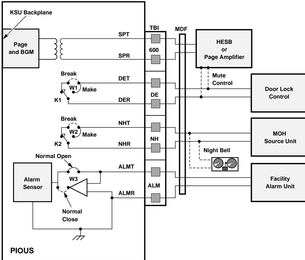
DK40i/DK424 Universal Slot PCB Wiring
