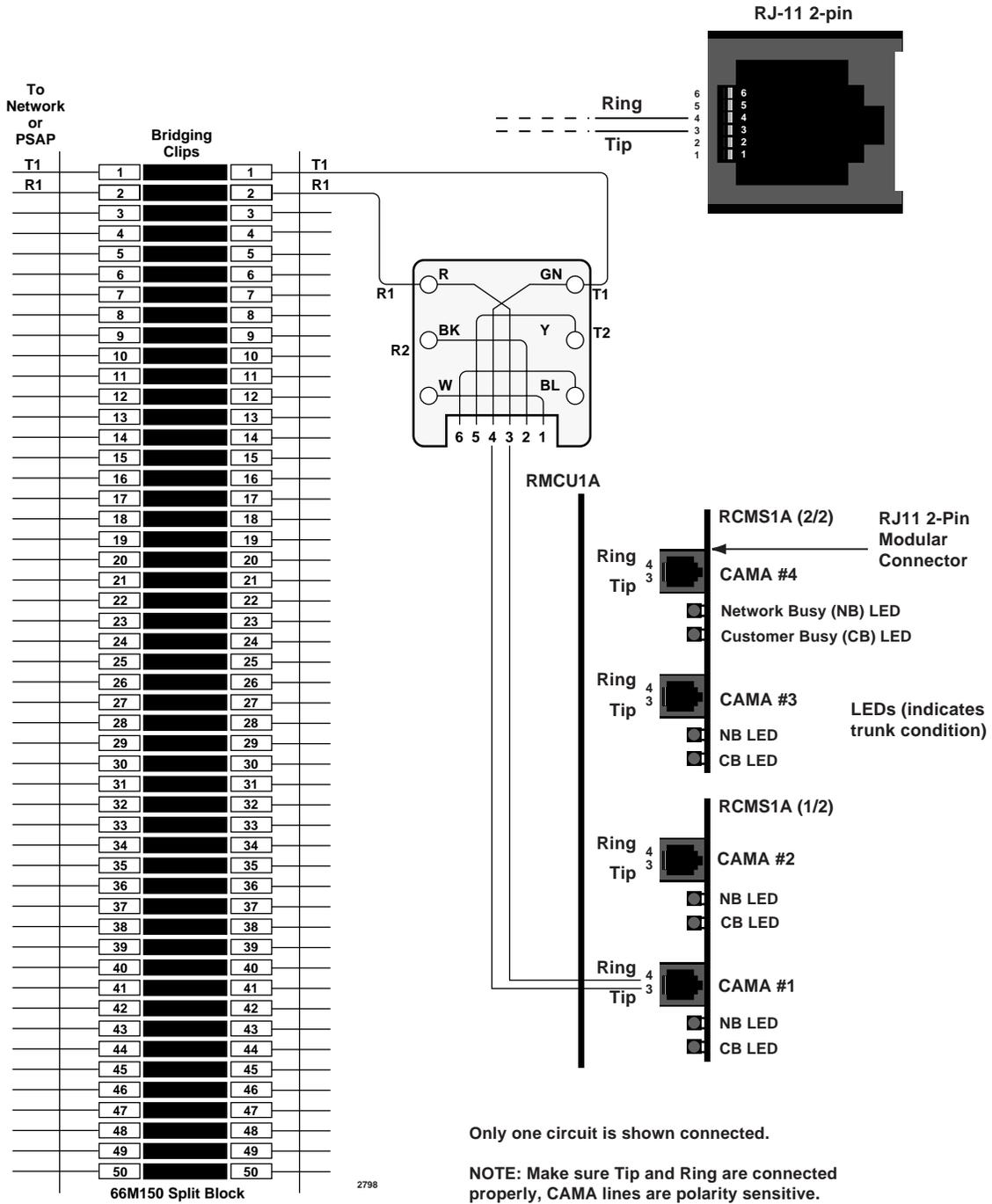
DK40i/DK424 Universal Slot PCB Wiring
